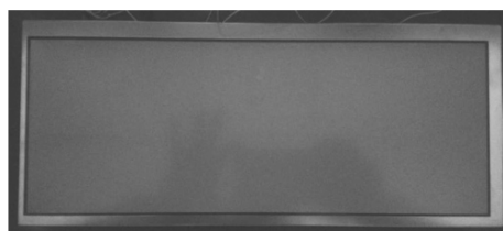
图12 压缩比75%,厚度0.6 mm泡棉
